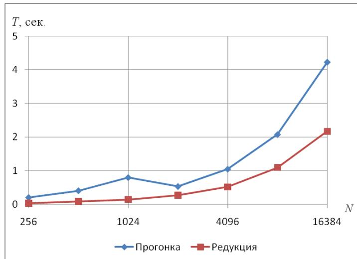
Рис. 3.15. Зависимость времени решения от размера матрицы
